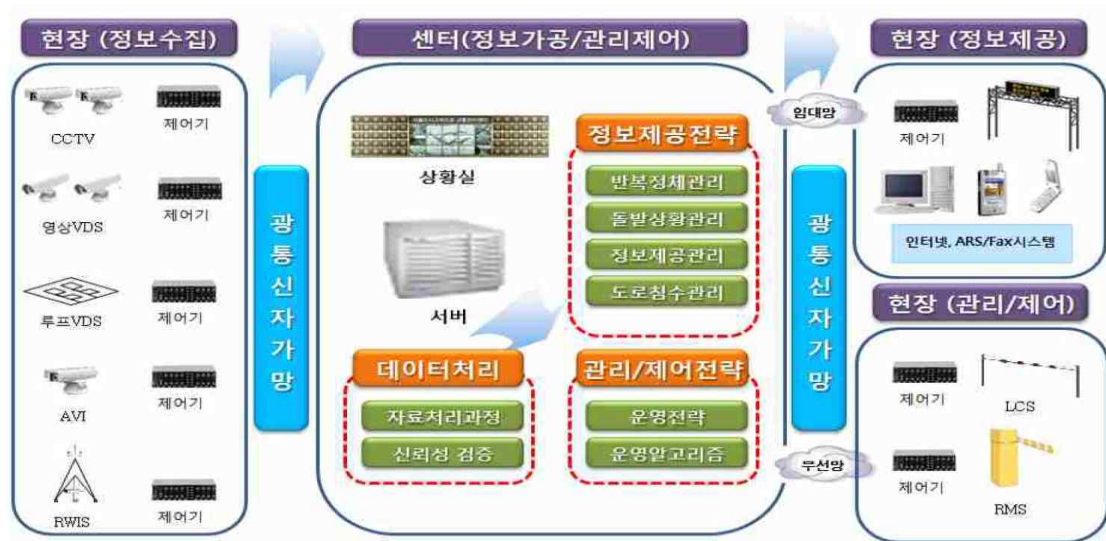
그림 2. 도시고속도로 교통관리시스템 구성
