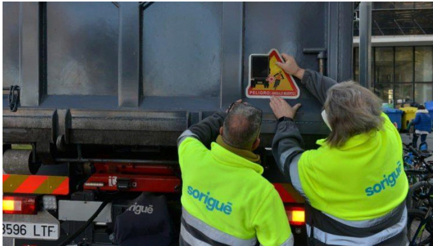
[사진] 물류 차량으로 인한 교통사고를 줄이기 위해 물류 차량의 사각지대에 신호판을 부착
