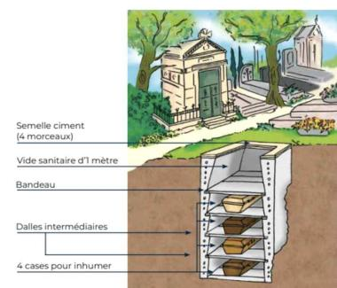
**Le caveau** est une construction souterraine en béton. Il permet la pose immédiate du monument.
